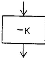
22 FINAL CONTROLLING FUNCTION (CONTROL VALVE OR DRIVE)
